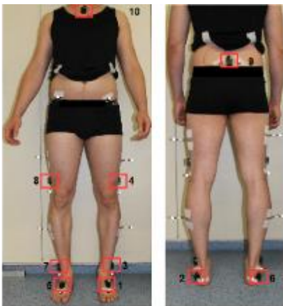
Abb. 1: Instrumentierte Versuchsperson mit 10 IMUs und dem Plug-In-Gait (lower-body) Markerset
