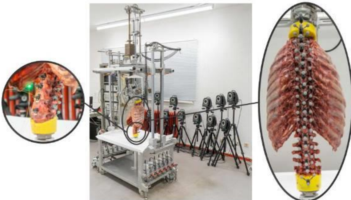
Abb 1. Darstellung des experimentellen Aufbaus inklusive eines humanen thorakolumbalen Wirbelsäulen- und Brustkorbpräparats im Wirbelsäulenbelastungssimulator zusammen mit einem Bewegungsanalysesystem bestehend aus zwölf Kameras (Mitte), intradiskalen Drucksensoren für die lumbale Wirbelsäule (L1-L5, links) und retroreflektiven optischen Markern für jeden Wirbel (C7-S, rechts).
