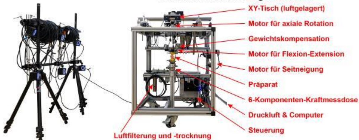
Abb1: Versuchsaufbau bestehend aus optischem Bewegungsanalyzesystem und neuem portablen Wirbelsäulenbelastungssimulator mit bovinem Schwanzsegment. Wichtige Komponenten der neuen Prüfmaschine sind rot beschriftet.
